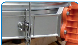
Supporto motori realizzabile in acciaio al carbonio o in acciaio inossidabile
