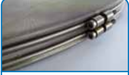
İkiz kelepçeli elek tabanları ile yerinde kolay boyut ayarlama
