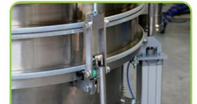
Cierres rápidos para facilitar montaje y cambio de tamices rápidos
