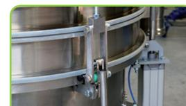
Assemblage des viroles par grenouillères pour un démontage et un remplacement rapide des tamis
