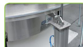
Système de levage pneumatique breveté
