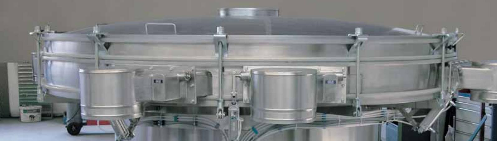
Простота в исполнении оборудования позволяет быстро скорректировать рассев в соответствии с вашим техническим заданием для 2 до 7 фракций на машину, с сохранением максимальной эффективности процесса.
