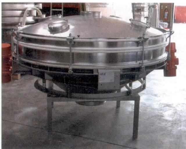
**Diese Siebmaschine verfügt über einen Durchmesser von fast 2 m. Werkfoto**
